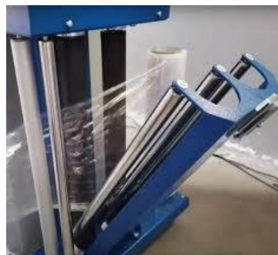
Palletizadora robusta con capacidad de carga de 1,5 TONS, cuenta con sistema de Carro con Pre estiro de 250% , hasta 5 programas, cuenta con función manual y sistema de enhebrado rápido Altura Envoltura Máxima 2100mm.
