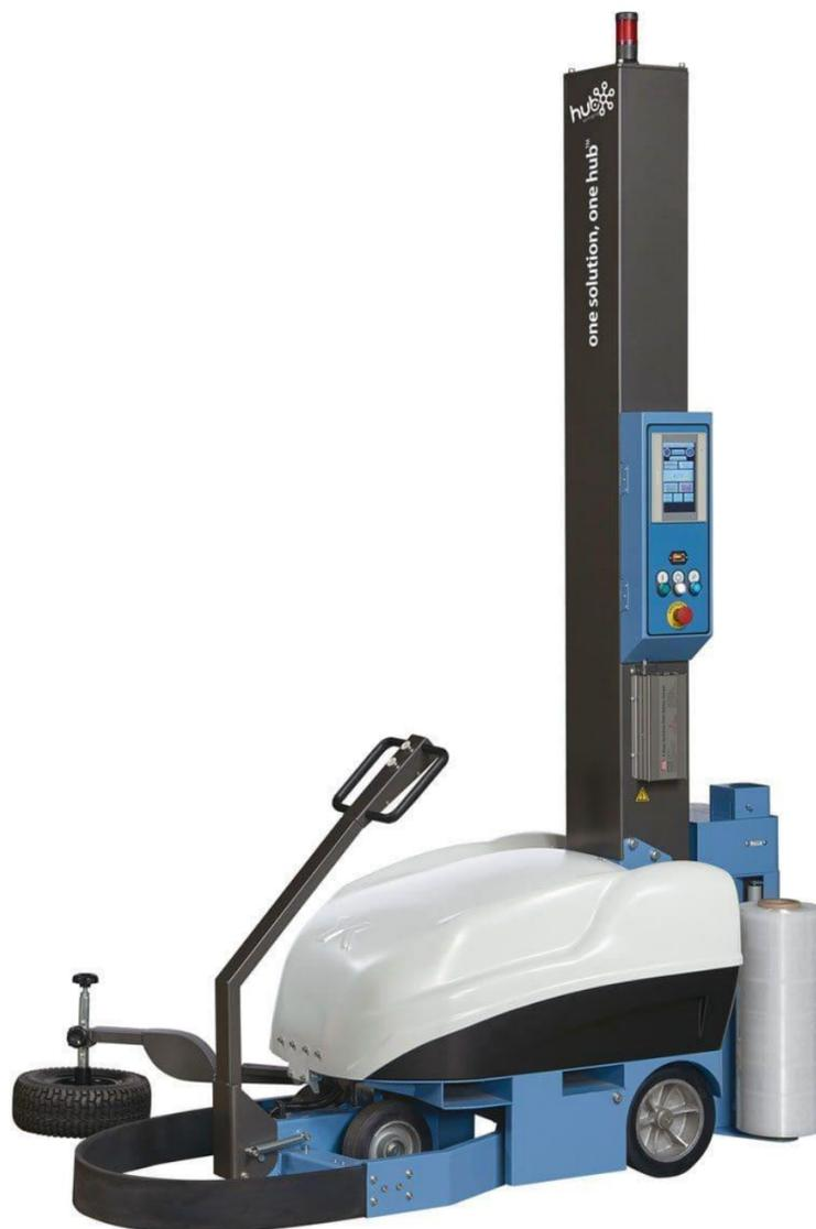
Robot Palletizador Extend EXP630 PLUS, Cuenta con Panel Touch Screen y el pre estiro Puede ser regulado fácilmente de 230% a 300% de enhebrado muy simple, con corte Automático del Film, vueltas inferiores y superiores pueden ser ajustadas desde el panel También pueden ser ajustadas las velocidades de la rueda rotatoria guía y del carro. Puede utilizar password de acceso al panel de control, cuenta con sensor de altura.
