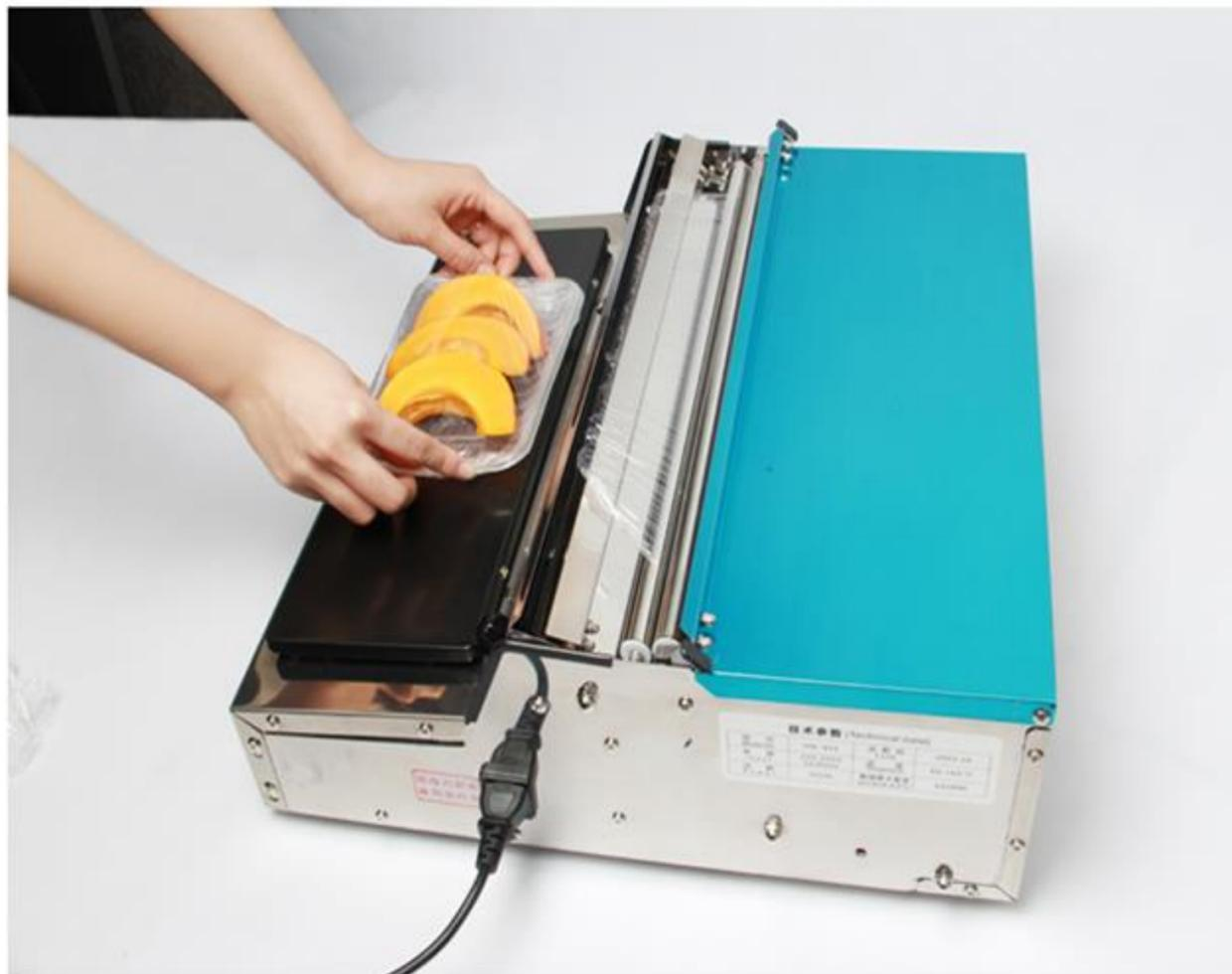
Dispensador diseñado para Aplicar Film de PVC ya sea como envoltura o relleno, puede ser utilizado en la industria Hotelera, Restaurantes, Locales de Comida, Uso Casero, Etc. Esta Fabricado en Acero Inoxidable lo cual lo hace mas durable y resistente a la corrosión. El diseño permite que al estar el rollo protegido no quede expuesto al polvo y cuya bandeja permite operar fácilmente por ser espaciosa y plana.
